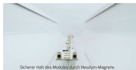
Sicherer Halt des Modules durch Neodym-Magnete.
