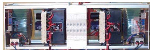
24VDC Sonderausführung für den Redundanzeinsatz
