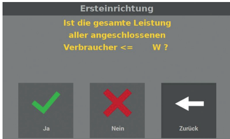
Abb. 39: Bestätigung der angeschlossenen Gesamtleistung
