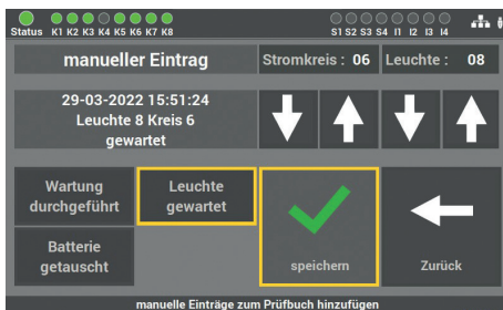
Abb. 71: Maske „Manuelle Dokumentation – Wartung Leuchten“
