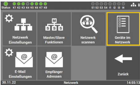
Abb. 144: Geräte im Netzwerk
